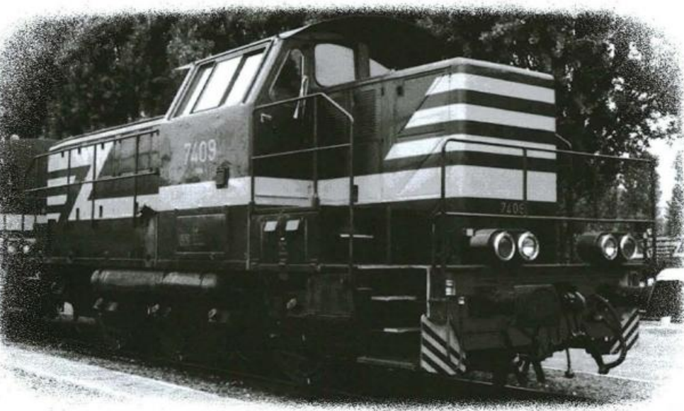
Diesellocomotief van het type 74, ingezet voor het goederenvervoer en in de rangeerstations.
